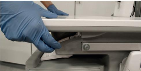
Der IT-Visitenwagen ist höhenverstellbar. Ziehen Sie den Hebel unterhalb der Arbeitsplatte nach oben und verstellen Sie dann den Wagen in die gewünschte Höhe. Benutzen Sie dazu zwei Hände.
