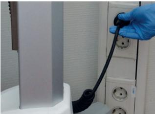
Es wird empfohlen, den Wagen bei längerer Nichtbenutzung an die Stromversorgung anzuschließen. Stecken Sie dafür den Stecker in die Steckdose.
