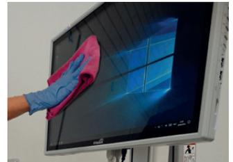
Der Bildschirm kann mit einem Fasertuch und einem nicht aggressiven Reinigungsmittel gereinigt werden (d. h. nicht mit einem Mittel auf Alkohol- oder Chlorbasis) Geben Sie das Reinigungsmittel auf ein Tuch und reinigen Sie den Bildschirm.
