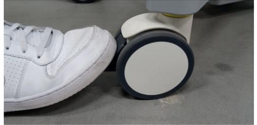
Lösen der Bremse: dieselbe Fußbewegung von oben nach unten.
